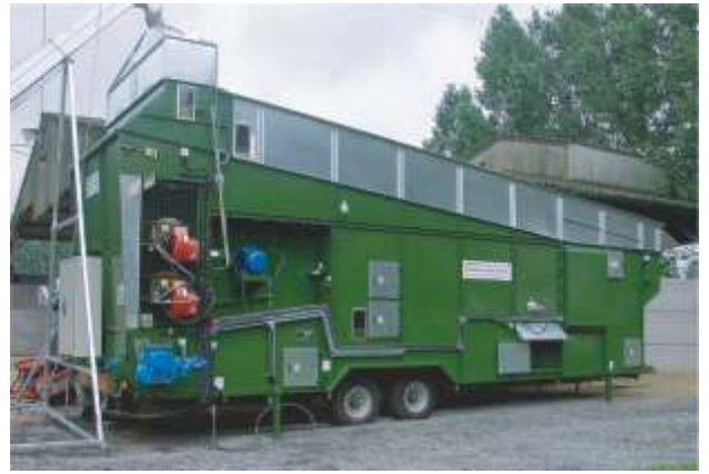
MDF 22000 típusú 25 t/h-s mobil szárító
