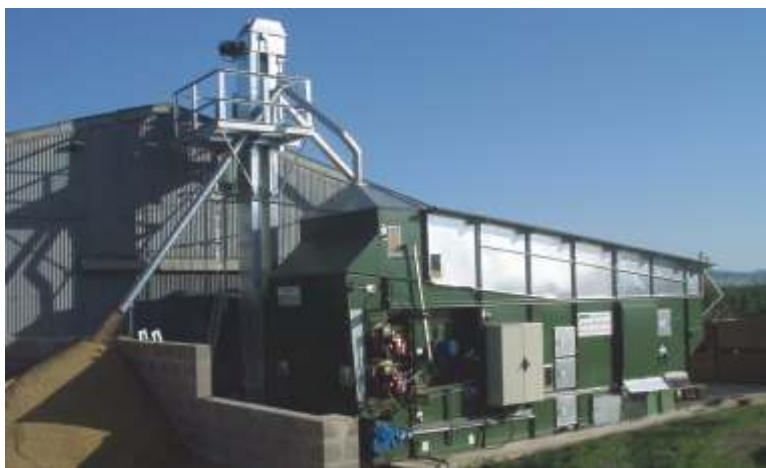
↑ Tipikus farmgazdasághoz méretezett szárítástechnika - DF 17750 szárító - 19,5 t/h
